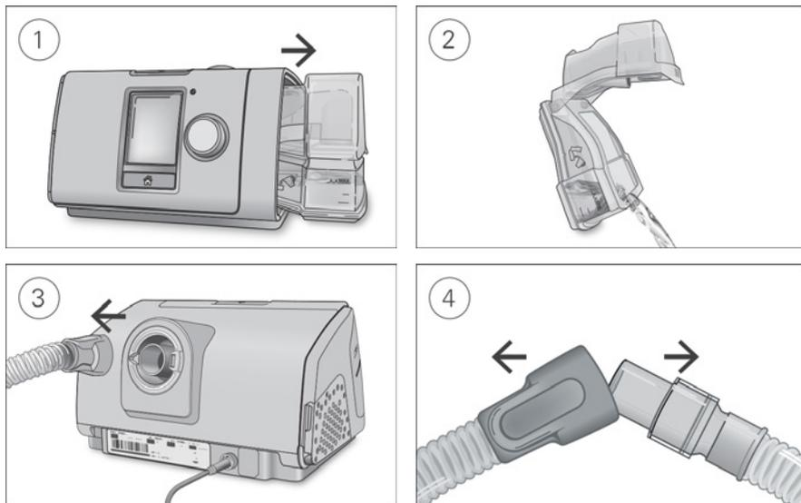
1. Sostenga el humidificador por la parte superior e inferior, presiónelo con suavidad y tire hacia afuera del equipo.
