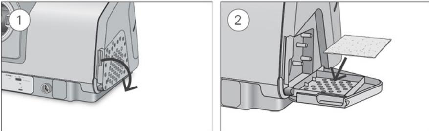
1. Abra la cubierta del filtro de aire y retire el filtro de aire antiguo.
